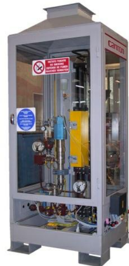
Статический миксер внутри вентилируемого бокса
