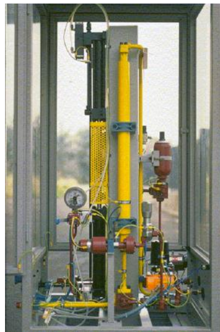
Статический миксер внутри вентилируемого бокса
